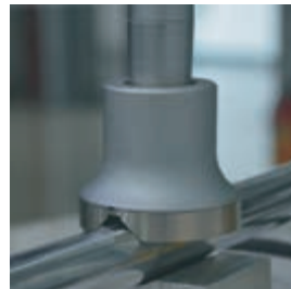
Küçük Silindirik Destek Halkasıyla Silindir Sertliğini Ölçme
